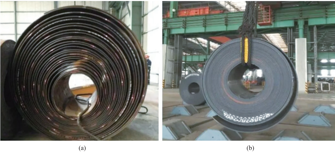
图 6 19.65mm 厚度规格 X70 钢卷开发生产 (a) 基于传统层流冷却的低温卷取工艺; (b) 基于超快速冷却的卷取工艺
