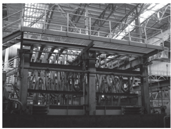
图 8a 鞍钢 4300 厚板超快冷装备
