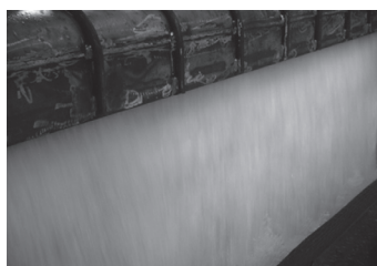
图6 开发的热连轧线超快速冷却狭缝式喷嘴及出口流量情况
