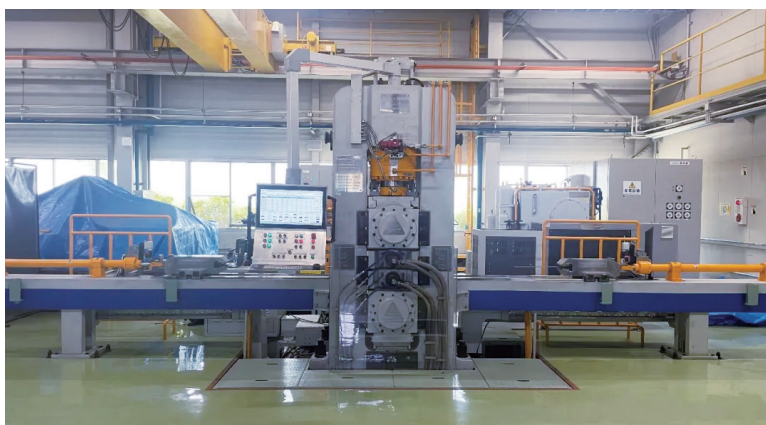
日本冶金 350mm 液压张力冷 - 温轧实验轧机
