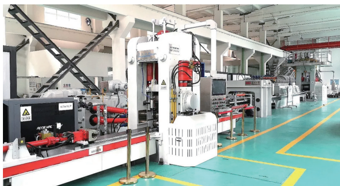
攀钢 550/350mm 热 - 温 - 冷轧实验轧机
