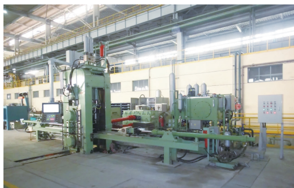
宝钢 350mm 液压张力冷 - 温轧实验轧机
