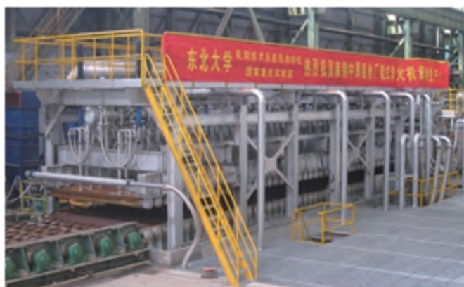
图 1 中厚板辊式淬火成套装备
