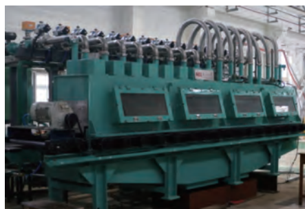
紧凑型组合式快速控制冷却中试设备
