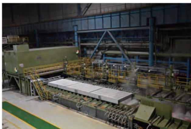
RAL 开发的首钢迁钢 2160mm 热轧带钢超快速冷却系统
