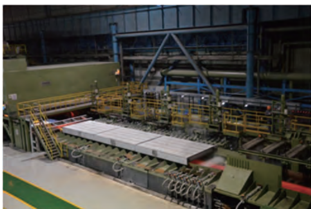
RAL 开发的首钢迁钢 2160mm 热轧带钢超快速冷却系统
