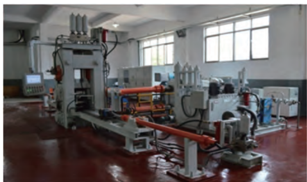
沙钢钢铁研究院高刚度液压张力四辊冷(温)实验轧机
