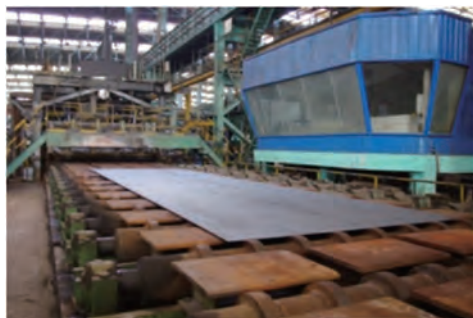
改造后淬火钢板板形照片 (6mm×2800mm×11000mm NM360/Q890D)
