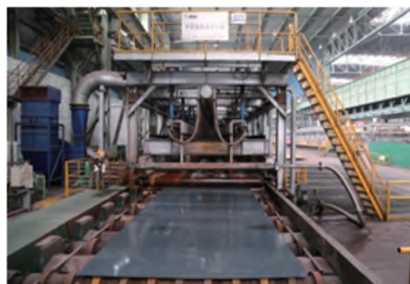
图 2 5mm Q1100 高强钢板连续稳定生产
