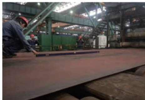
改造后淬火钢板板形照片 (6mm×2800mm×11000mm NM360/Q890D)
