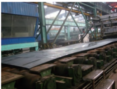
设备改造前淬火板形照片 (12mm×2500mm×11000mm Q690D)
