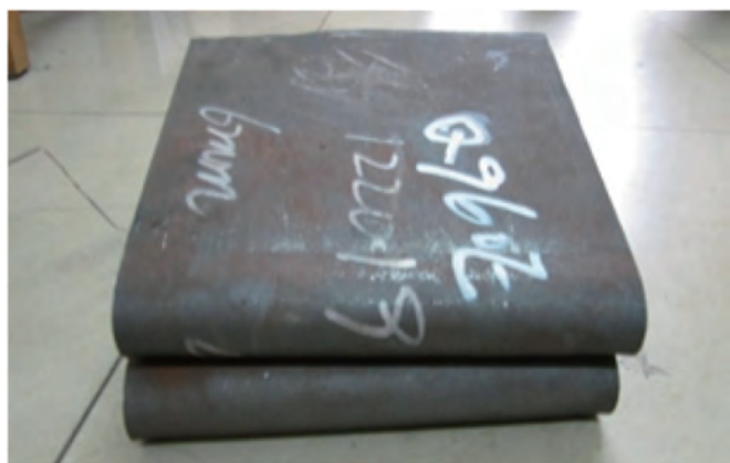
图 3 热处理后 Q960E 冷弯性能良好
