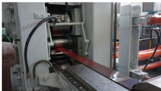
薄带钢在恒温微张力工艺环境下的温轧实验过程
