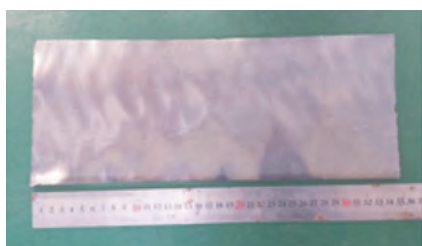
0.30mm 厚 6.5% Si 电工钢薄带
