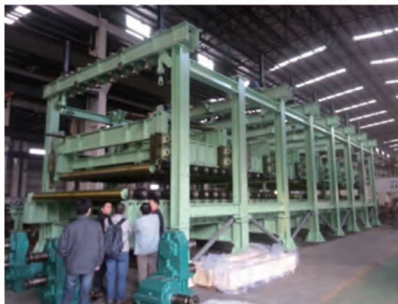
重钢 4100mm 辊式淬火机设备 A 检情况
