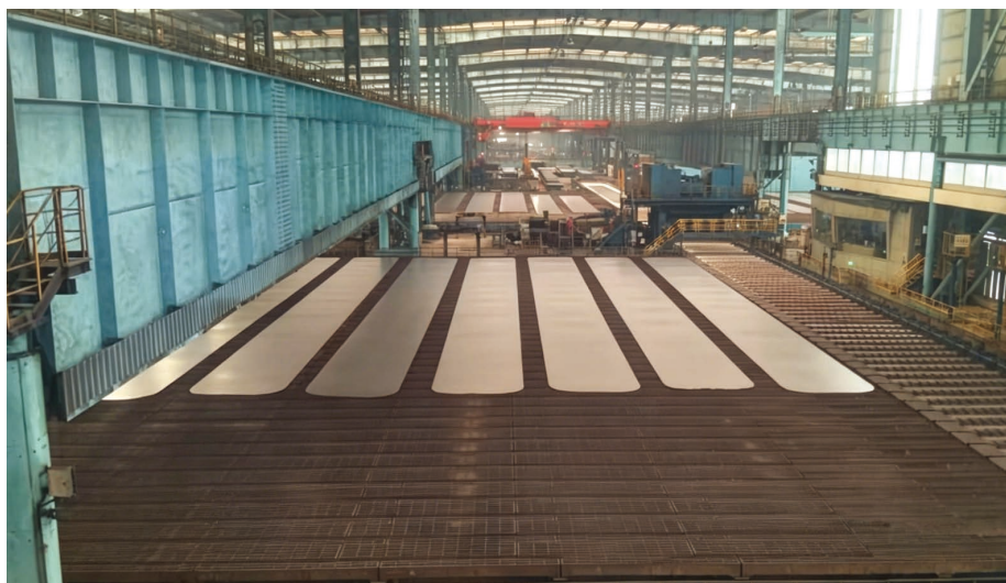
图4 基于自动镰刀弯控制的8 mm钢板控制效果
