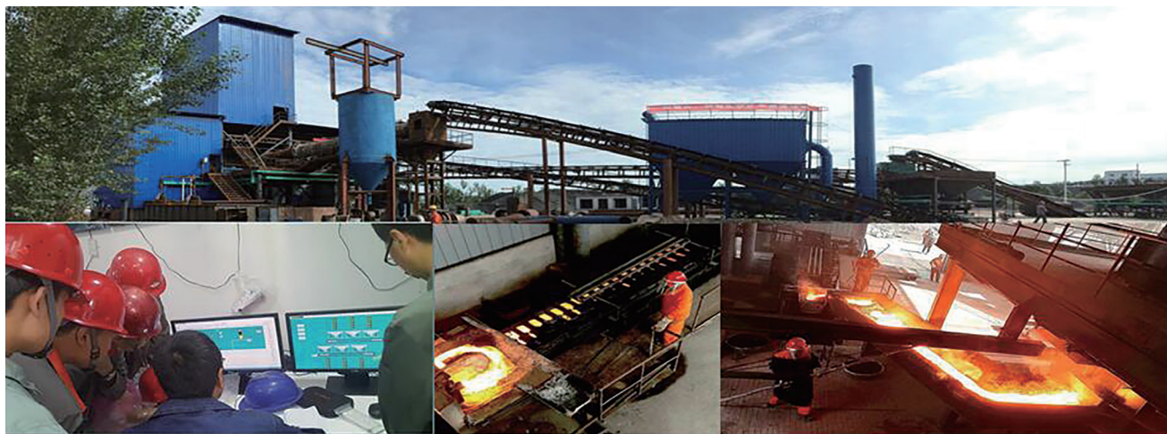
处理能力 50 吨 / 天的深度还原短流程熔炼系统
