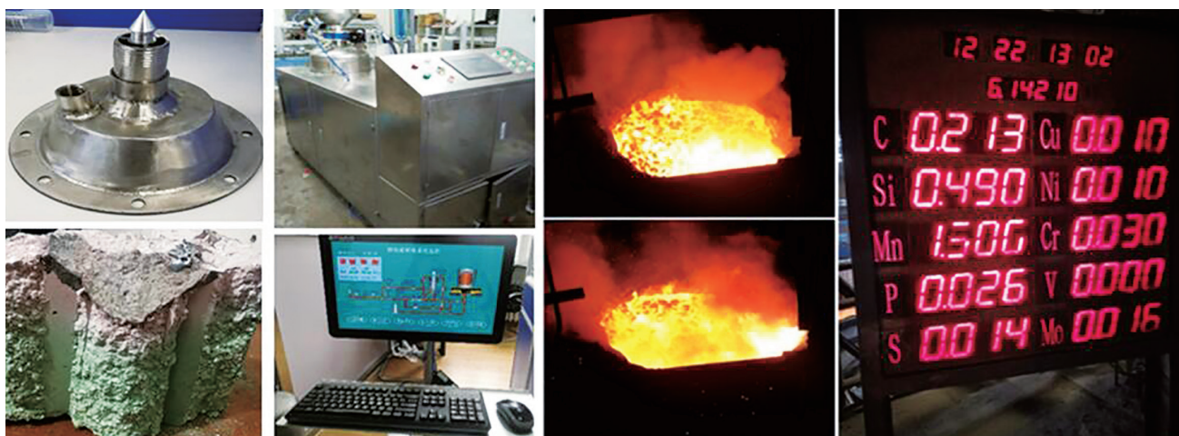
底喷粉元件、自动化控制装备及现场应用
