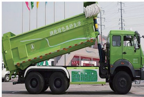
在线淬火生产的耐磨钢板及其在绿色环保渣土自卸车上的应用
