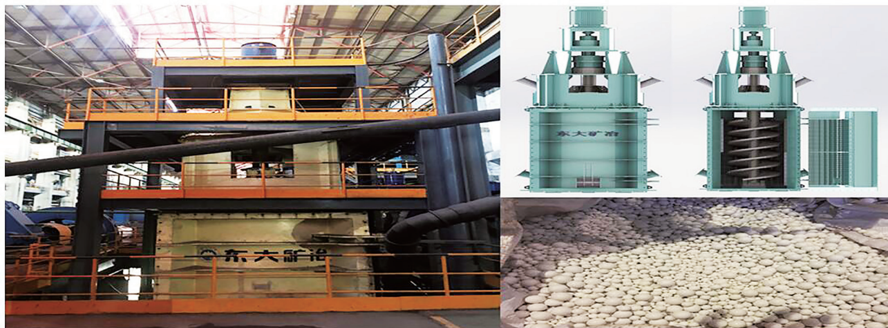
NEU-280kW 新型陶瓷球搅拌磨机
