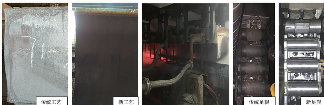
铸坯偏离角凹陷控制效果对比
